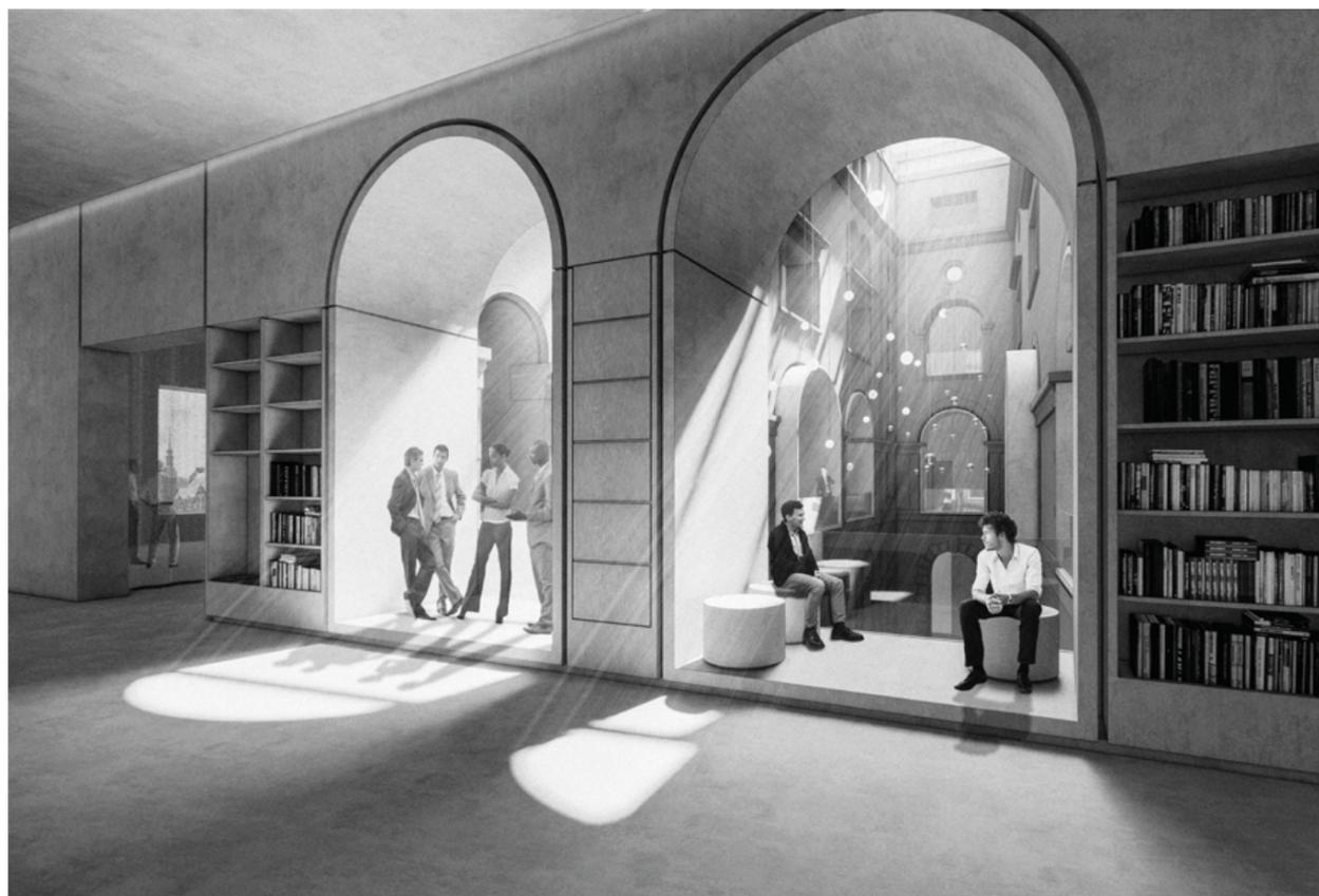
↑ Der Innenhof wird zum Innenraum, wodurch die Fenster geöffnet werden können, in die bestehenden Öffnungen werden dünne Betonrahmen gesetzt
