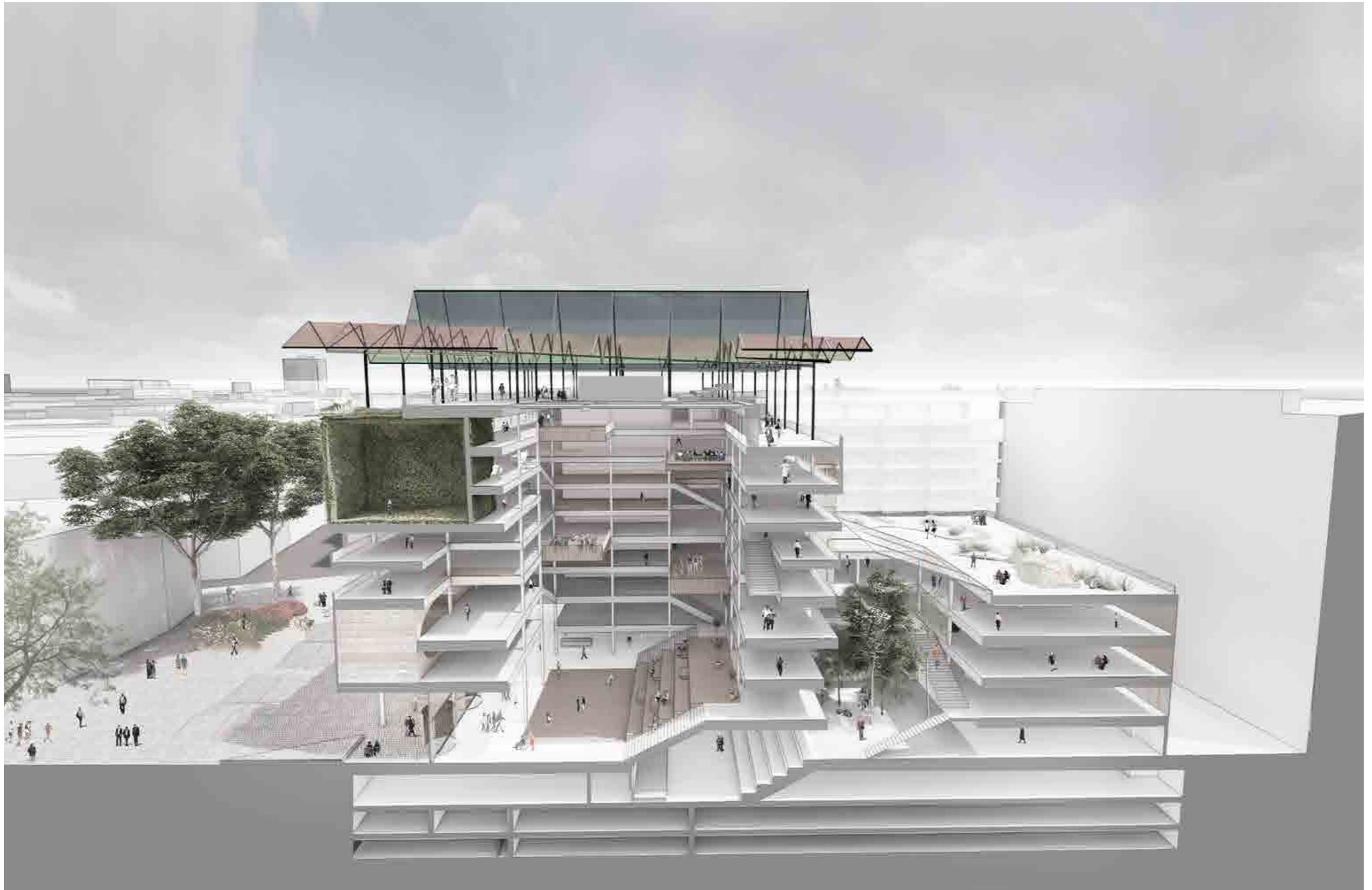
↑ Der zentrale Luftraum, die vertikale Agora, verbindet alle Geschosse; er empfängt die Besucher bereits im Erdgeschoss und führt sie hinauf bis zur Dachterrasse The central air space, the vertical agora, connects all floors; it welcomes visitors on the ground floor and leads them up to the roof terrace
